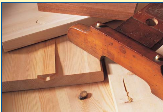
5 Με το δισκοπρίνο και πολλές παράλληλες εγκοπές, αφαιρέστε τα ελαττωματικά σημεία στις ακμές. Κολλήστε στα ανοίγματα τα κατάλληλα πηχάκια.
