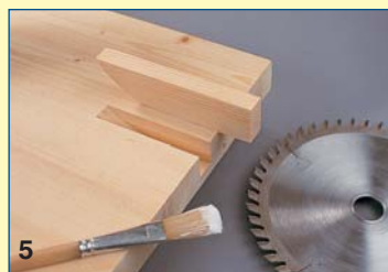
5 Με το δισκοπρίνο και πολλές παράλληλες εγκοπές, αφαιρέστε τα ελαττωματικά σημεία στις ακμές. Κολλήστε στα ανοίγματα τα κατάλληλα πηχάκια.
