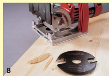
8 Μία φρεζοκαβιλιέρα είναι απαραίτητη σε βαθιές «φωλιές» ρετσινιού. Στα скаμμένα σημεία τοποθετούνται λαμέλα ή κομμάτια από το ίδιο ξύλο.
