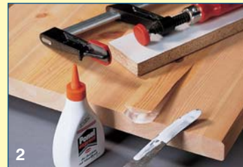
2 Με ένα μαχαίρι ανασηκώνετε τους ετήσιους δακτύλιους. Τους κολλάτε ξανά στη θέση τους, σφιγμένους με σφιγκτήρα και με έναν ξύλινο τάκο.
