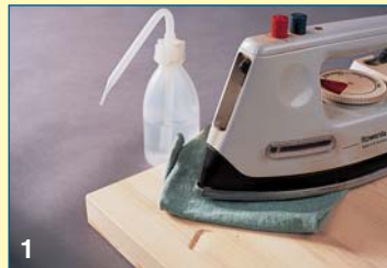
1 Βαθουλώματα από ελαφρά χτυπήματα εξαλείφονται με σιδέρωμα των συμπιεσμένων ινών. Αφού τις βρέξετε, κατόπιν τις σιδερώνετε.
